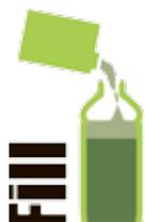
Добавьте отвердитель до уровня «а»: всего 250мл в соответствии с пропорцией смешивания 3:1. Для колеруемой версии добавьте концентрированный пигмент или пасту. Допускается использование базового покрытия без добавления биндера. Колер должен занимать не более 10% от смеси RAPTOR+отвердитель.
